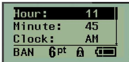
**Nota:** Al utilizar el formato de hora HH:MM:SS, no se visualizará ningún campo para los segundos. El reloj interno de la impresora inicia los segundos en función de los minutos que haya seleccionado.
